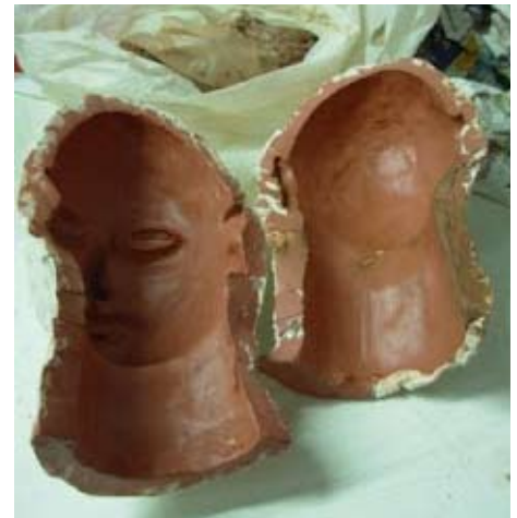
Figura 67.- Molde de dos piezas, las partes del molde deben de estar planeadas para que al hacer las copias no se atoren al desprenderlas del molde.
