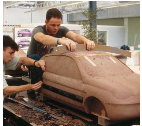
Figura 2. Las primeras maquetas de diseño de un automóvil, denominadas clay, se realizan a escala 2/5 sobre un bloque de arcilla sintética.
