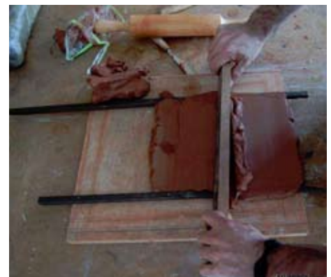
Figura 33. Usando dos tiras como y un racero se puede nivelar la superficie de la base.
