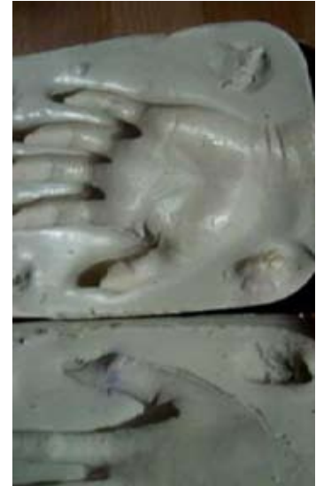
Figura 66. La mano puede servir para hacer un molde de dos piezas, se pone crema a la mano y se hace la primera parte, el yeso fragua en 15 minutos, se aísla el molde con jabón y se coloca nuevamente la mano para hacer la segunda parte del molde.
