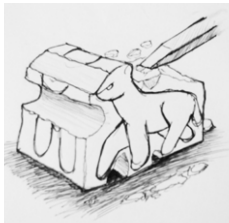
Paso 2. Desbaste con un cincel o formón, de zonas negativas o sea, las partes vacías donde no hay forma (figura 52).
