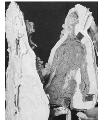
Figura 70. Separación de las secciones del molde.
